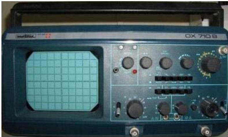
Pour visualiser une tension quelconque  $U_{AB}$  entre deux points A et B, il faut toujours relier la première lettre en indice de la tension (ici A) sur la voie d'entrée, et la deuxième lettre (ici B) sur la masse.
