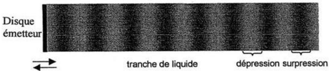
Lors du passage de l'onde dans une « tranche » de liquide, le phénomène de cavitation se produit si la puissance de l'onde est suffisante : des microbulles de vapeur dont le diamètre peut atteindre  $100 \mu\text{m}$  apparaissent. Les microbulles de vapeur sont transitoires. Elles implosent en moins d'une microseconde. Les ondes de choc émises par l'implosion nettoient la surface d'un solide plongé dans le liquide.
